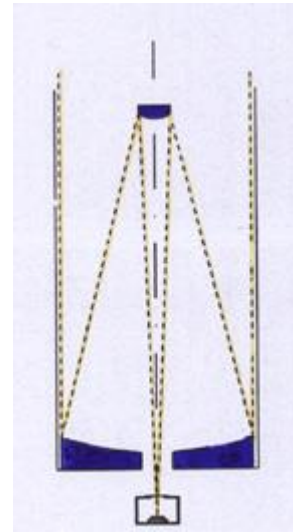
télescope Cassegrain (réflecteur): le miroir focalise les rayons lumineux au foyer de l'instrument situé derrière le miroir percé d'un trou
