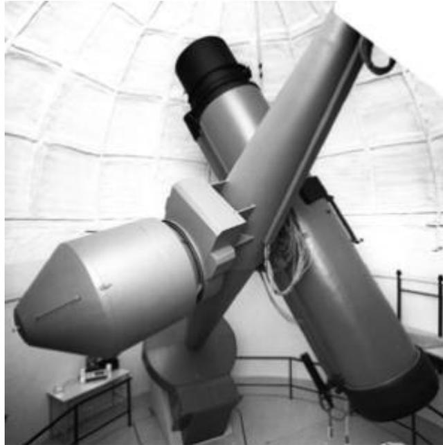
*Télescope de Schmidt : ces télescopes, dont l'ouverture est de l'ordre de 1 mètre, construits aussi à de nombreux exemplaires, permettent d'obtenir un champ astronomique de plusieurs degrés et ont cartographié l'ensemble du ciel.*
